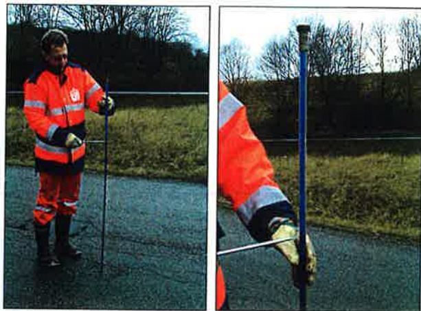
Figur 10-3 Avläsning av tjälgränsmätare enligt Gandahl. (Foto: VTI Maria Arm)
