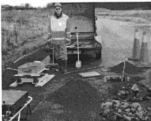
Figur 15-19 Provgrop i sträcka 5 med fältsiktat förstärkningslagermaterial av naturgrus. Sträckvånster om vägmitt på den enkelriktade provvägen. (Foto: VTI Maria Arm, 1998)
