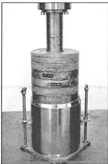
Figur 4-1 CBR-försök på laboratoriepäckat prov med överlast (Arm et al., 1995)
