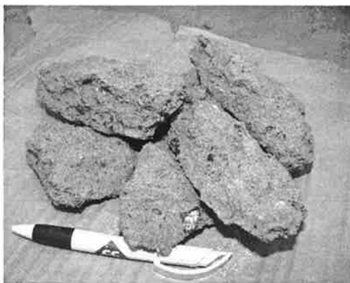
Figur 16-25 Material som grävts upp ur ett två år gammalt förstärkningslager av krossad betong. (Foto: VTI Jörgen Svensson, 1999)
