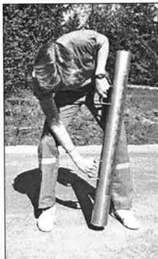
Figur 4-8 Fältmätning med LOADMAN (Arm et al., 1995)
