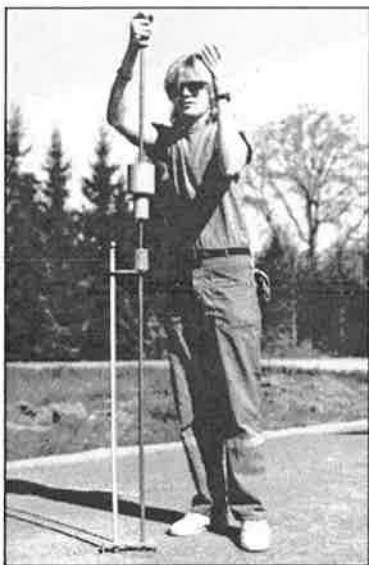
Figur 4-4 Fältmätning med DCP (Arm et al., 1995)
